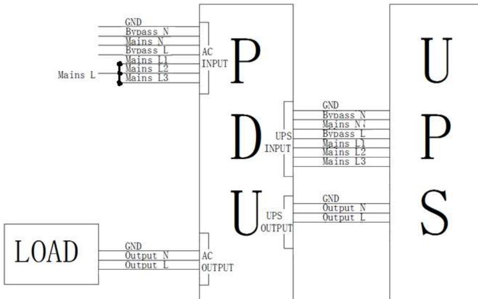
Fig. 5-4 Conexión de Entrada monofásica - Salida monofásica
