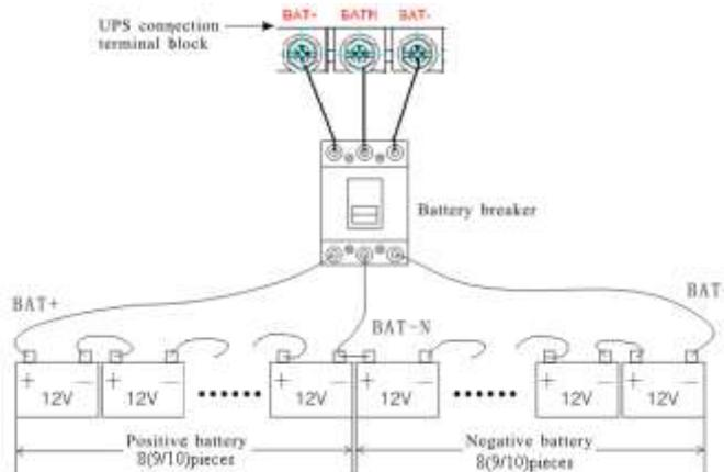
Fig. 5-5 Conexión batería
