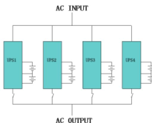
Fig. 5-6 Instalación de SAI en paralelo
