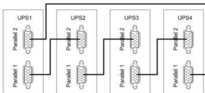
Fig. 5-7 Conexión de equipo en paralelo
