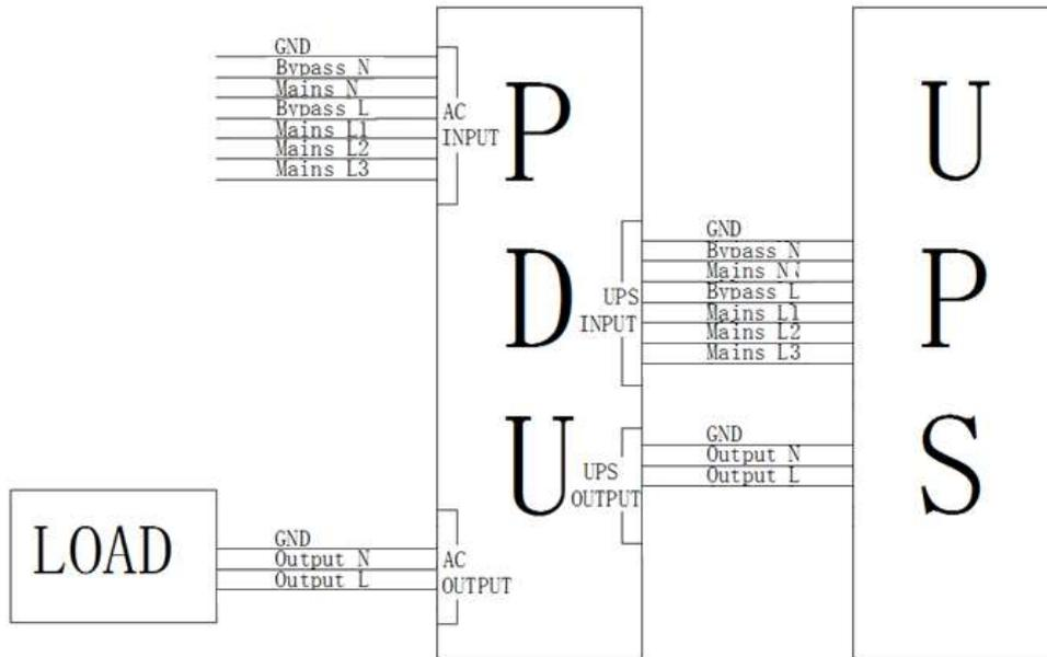
Fig. 5-3 Conexión de Entrada trifásica - Salida monofásica
