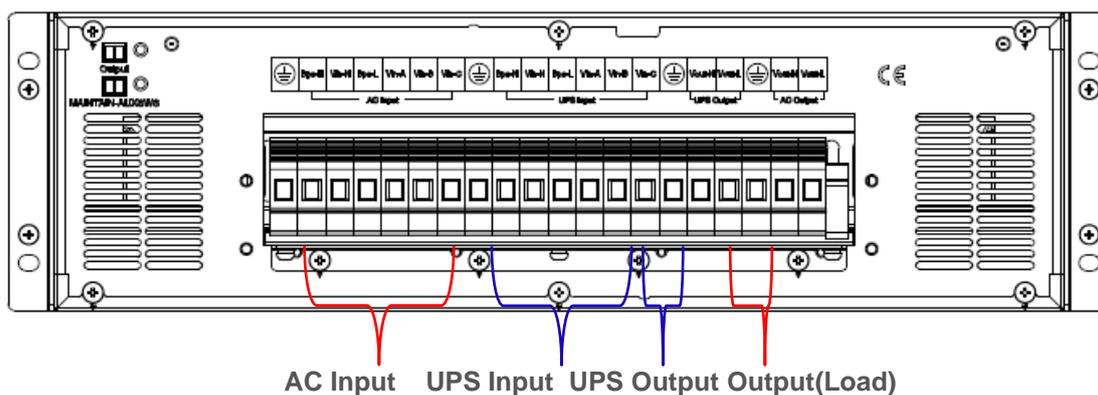
Fig. 5-2 Conexiones del modulo PDU externo (opcional)
