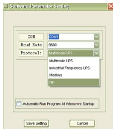
Fig. 5-19 Ajuste de parámetros de comunicación
