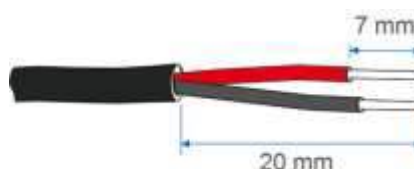
Fig. 4-45 Pelado de la capa de protección
