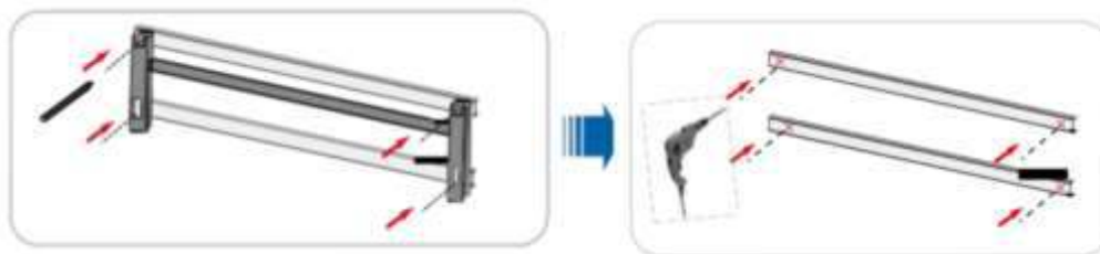
Fig. 4-11 Nivelar el soporte montado y marcar las posiciones para taladrar agujeros
