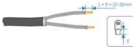
Fig. 4-50 Retire una cierta longitud de capa protectora
