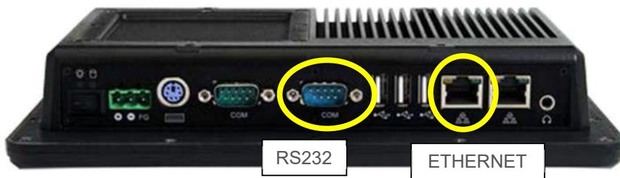
Fig. 5-1 Interfaz de Comunicación del AVC DVR de Alta Potencia
