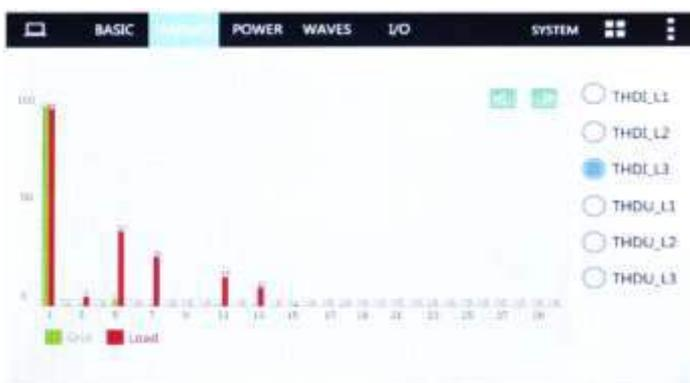
Fig. 3-7 Pantalla Diagrama de Barras de Harmónicos
