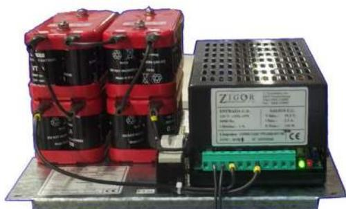
Fig. 2-4 TPS 120 implantado sobre una placa con las baterías VR.
