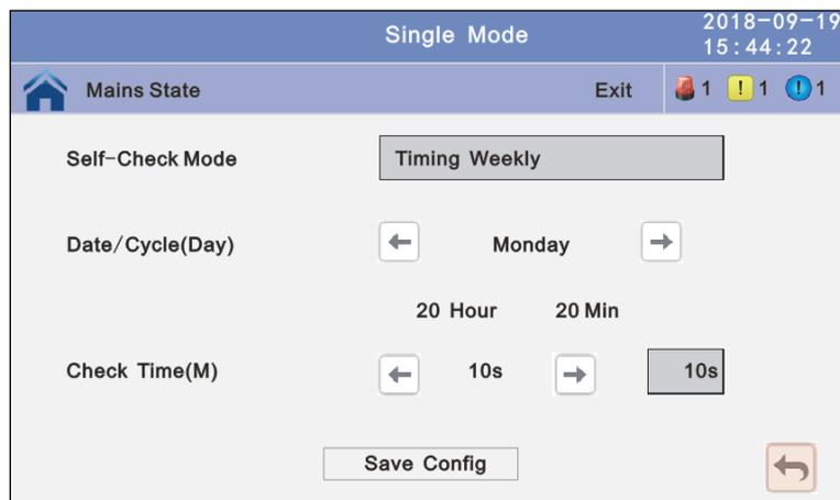
Fig. 4-53 Submenú Maint/Autocomprobación de la batería/Timing Weekly
