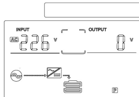
Fig. 4-5 Panel de control en modo standby
