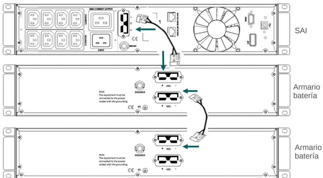
Fig. 3-2 Imagen ilustrativa de conexionado de batería con armarios tipo EFFICIENT RT
