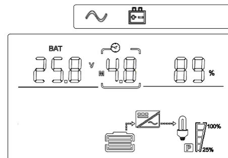
Fig. 4-3 Panel de control en modo batería
