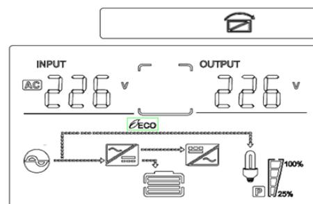
Fig. 4-6 Panel de control en modo ECO
