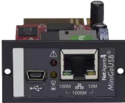
Fig. 5-5 Tarjeta SNMP/Modbus
