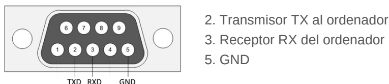
Fig. 5-3 Puerto de comunicación RS232
